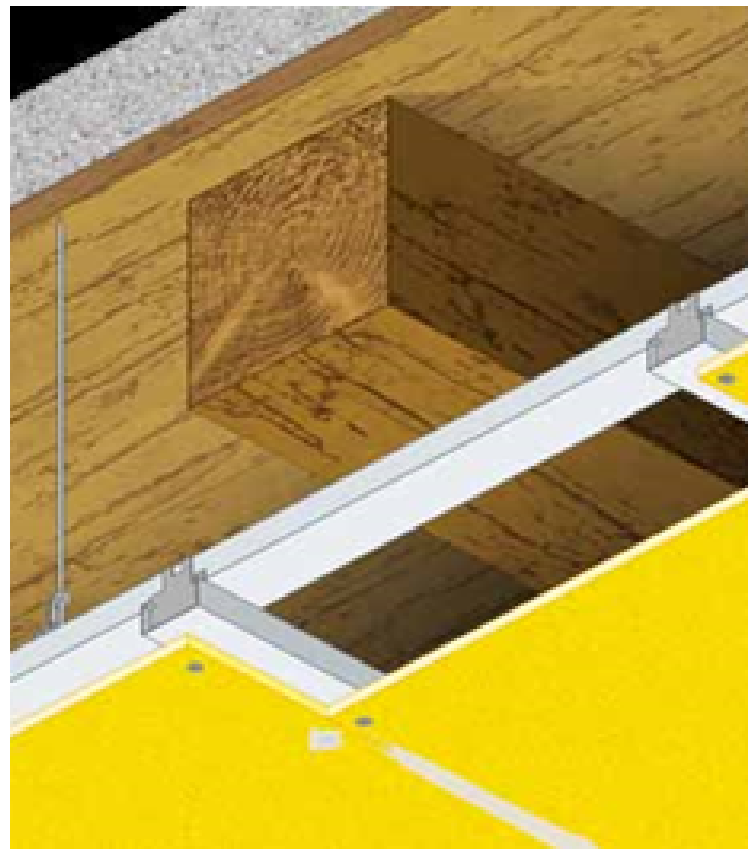
Protección de vigas y suelo de madera con placa de fibrosilicatos de 13 mm de espesor
